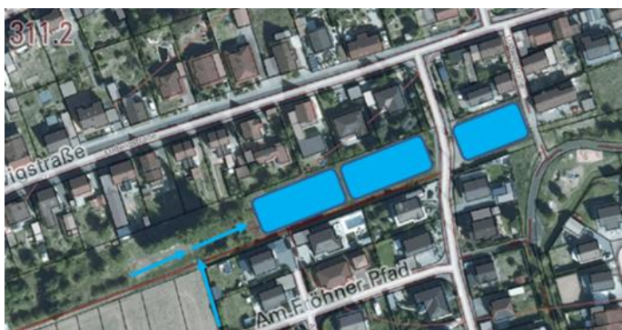
Abb. 26: Außengebiet (oben) zum und wasserwirtschaftliche Ausgleichsmaßnahme (unten) im Wohngebiet Dellchen I
