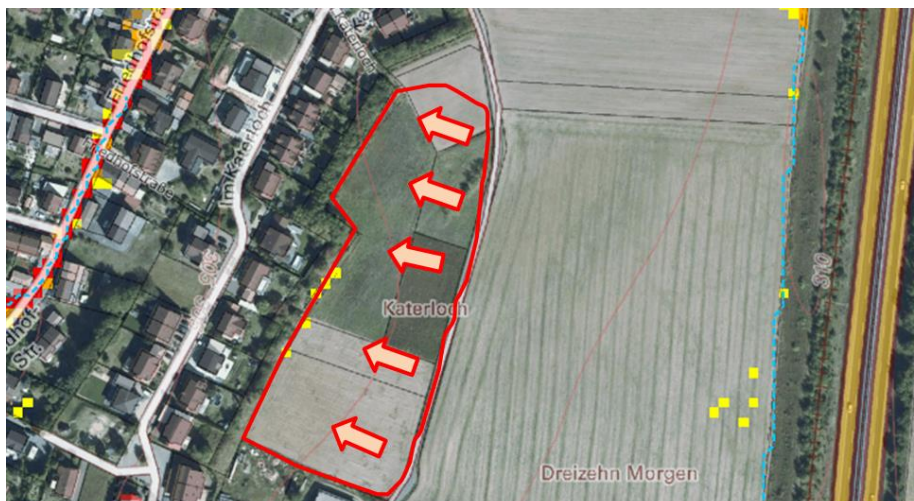
Abb. 66: Breitflächiger Oberflächenabfluss zum Lärmschutzwall Katerloch
