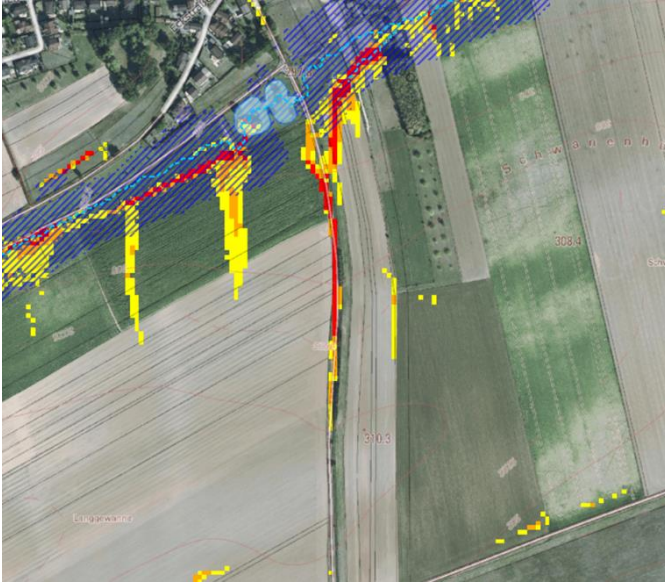
Abb. 36: Potenzielle Zuflusswege in die RRB-Kaskade
